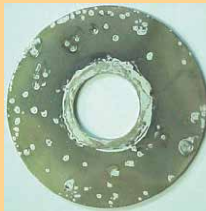
Figura 6: Aspecto superficial de cupones ensayados en el RA-6 (IZQ) y en el DCMFEI (DER). Diámetro: 10 cm.
