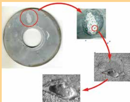
Figura 8: Ataque localizado sobre la superficie de un cupón ensayado en el Cementerio Húmedo del Reactor RA-6
