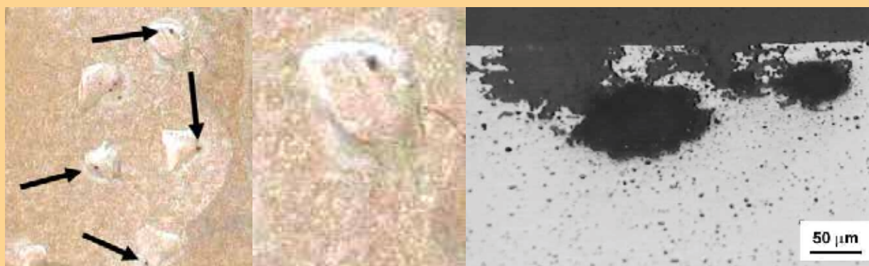
Figura 10: Picaduras formadas debajo de escamas de vidrio transparente Izquierda: vista general Centro: magnificación Derecha: metalografía de sección transversal
