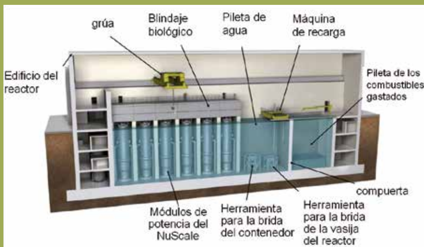
Figura 10: Edificio del reactor para 12 Módulos
