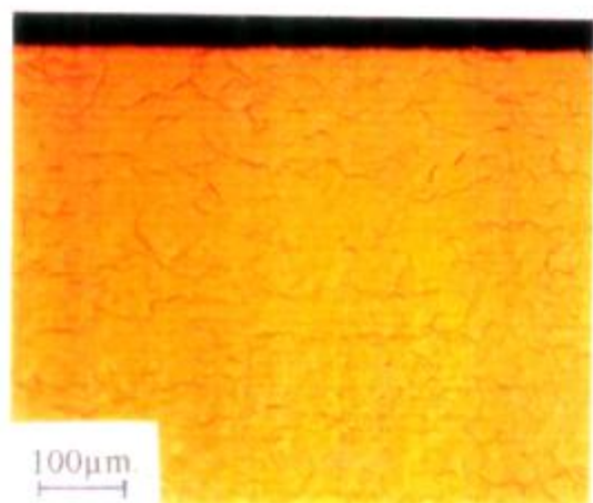
Figura 4-9: Muestra 1A. Material inmediato al óxido. 174 ppm en peso de hidrógeno.
