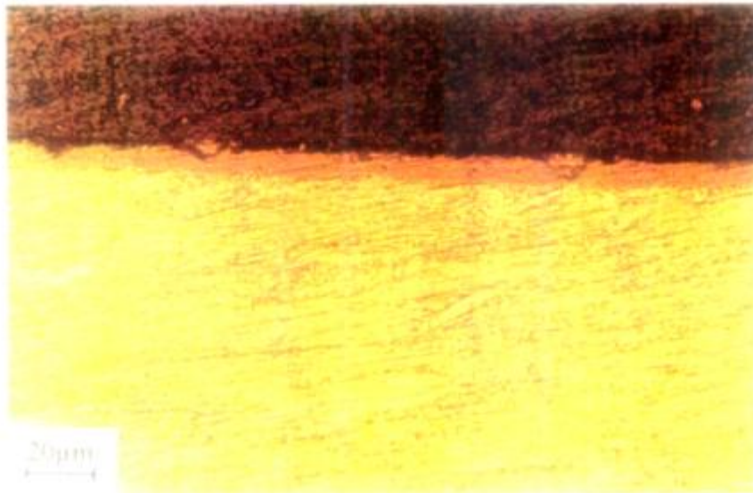
Figura 2-2: Muestra 4A, cara N°1, tercio medio. Espesor de óxido promedio medido por microscopia 10,1 \mu\text{m} .
