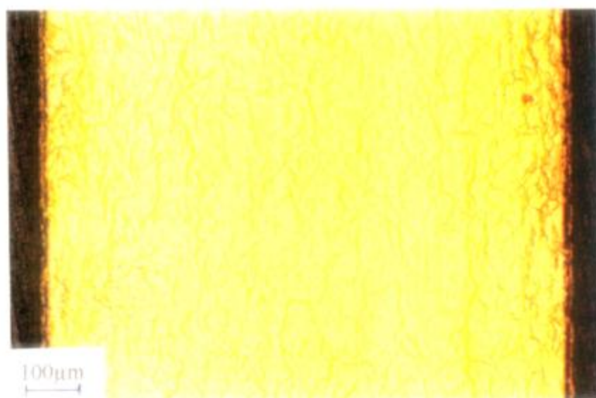
Figura 2-6: Muestra 3C, tercio medio Concentración de hidrógeno 565 ppm en peso.
