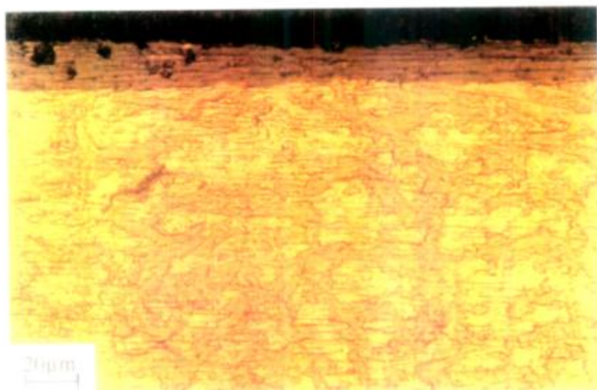
Figura 2-4: Muestra 3A, cara N°1, tercio medio Espesor de óxido promedio medido por microscopía 20,9µm
