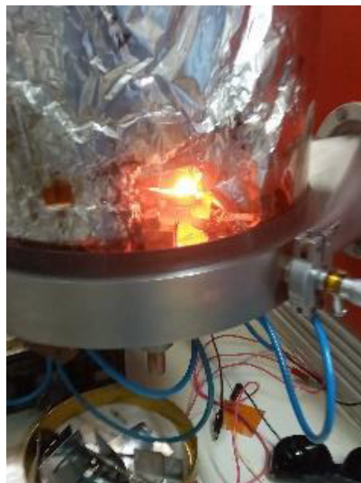
Figura 7. Evaporación por efecto Joule de Al sobre obleas de Si.
