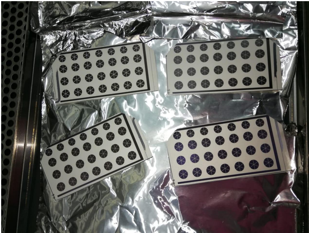
Figura 1. Vista de la grilla frontal de cuatro obleas con sensores solares luego del proceso de engrosado de contactos.
