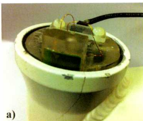
Figura 3.30. Dispositivos de ensayo montados. a) bobina plana montado en el tubo de dirección; b) bobina palpador montado en el tubo de dirección
