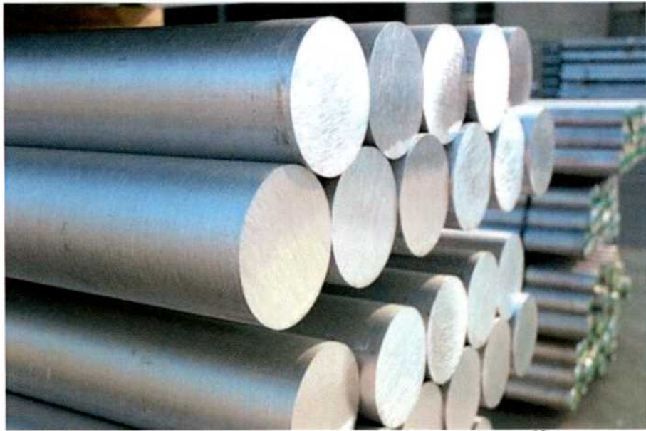
Figura 2.2. Lingotes de aluminio para extrudir. 19
