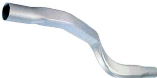
Figura 2.12. Perfil tubular hidroformado. 24
