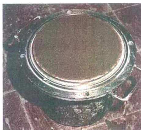
Figura III.3 Pastón elaborado para la confección de las probetas
