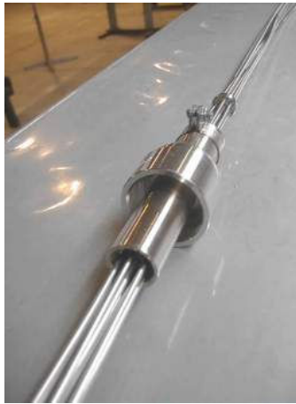
Figura 1.5.1b: Lanza de instrumentación In-Core (Mod. CNEA F100).
