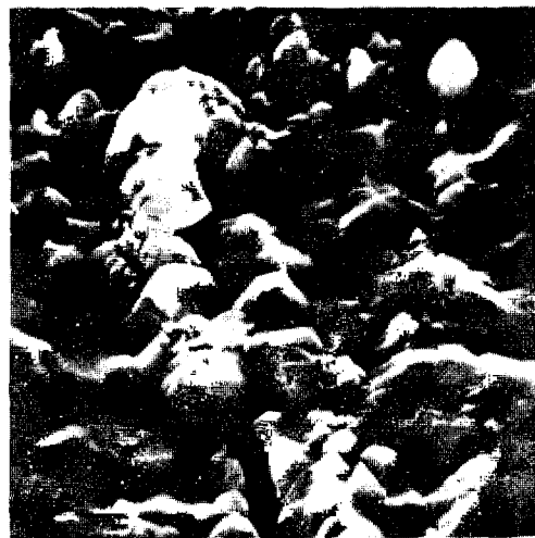
Fig. IV.13: Crack iniciado en una zona de una probeta de Zry expuesta a la acción del lodo, asociado con la presencia de elementos aleantes e impurezas. (Ref. 17) (X 10.000)
