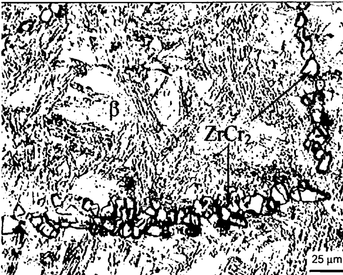
Figura IV-12- Micrografía de la aleación ZCS1 tratada térmicamente a 900°C con ataque químico. Fases \beta y \text{ZrCr}_2 .
