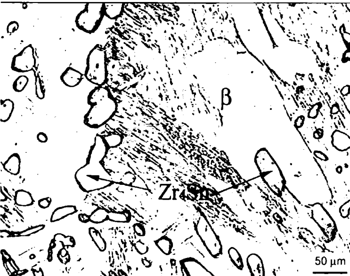
Figura IV-13- Micrografía de la aleación ZCS6 tratada térmicamente a 980°C con ataque químico. Fases \beta y \text{Zr}_4\text{Sn} .
