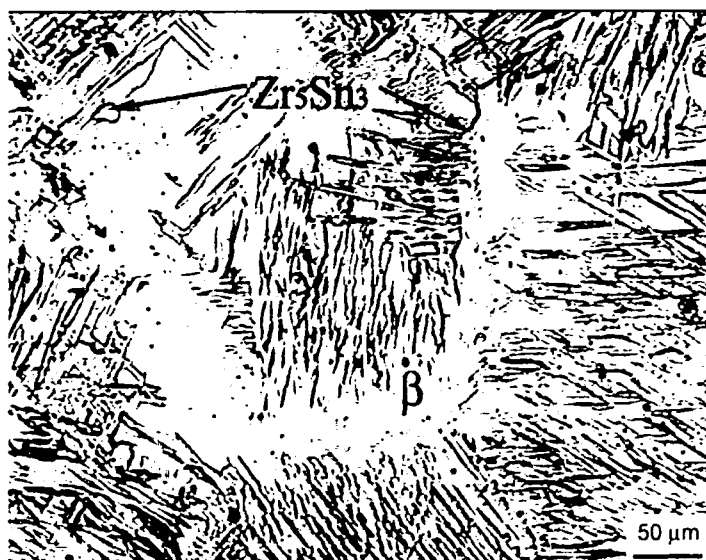
Figura IV-4- Aleación ZCS6. Microestructura de fundición (la fase \beta corresponde a \beta^I )
