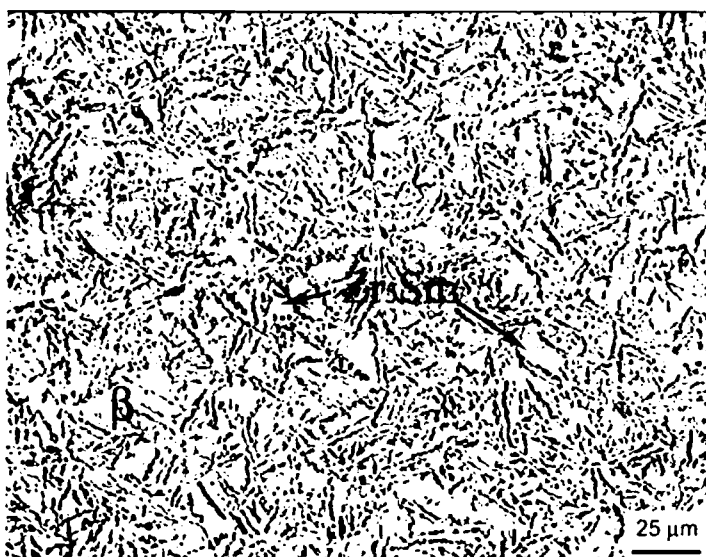
Figura IV-5- Aleación ZCS7. Microestructura de fundición (la fase \beta corresponde a \beta^I )
