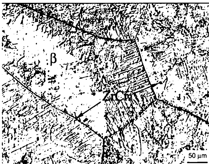
Figura IV-2- Aleación ZCS2. Microestructura de fundición (la fase \beta corresponde a \beta^I )
