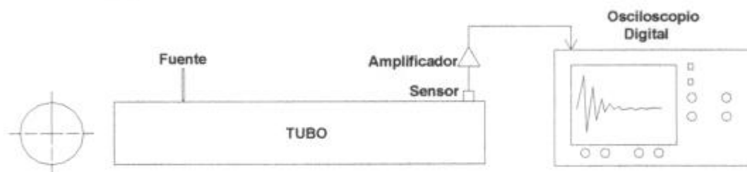
Figura 2.1 – Esquema de los ensayos con tubos.
