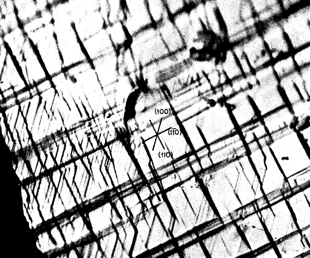
Microfotografía a 300 aumentos de monocristal de uranio beta. Se pueden observar tres sistemas de deslizamiento (en las direcciones indicadas por los ejes), incluyendo el nuevo sistema descubierto \{100\} \langle 001 \rangle .
