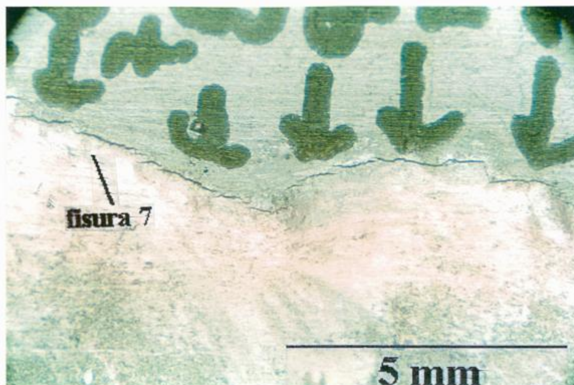
Figura 2.40: fisuras en talón de probeta nº 3
