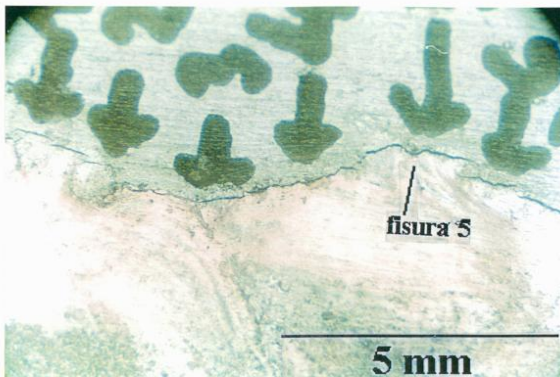
Figura 2.38: fisuras en talón de probeta nº3
