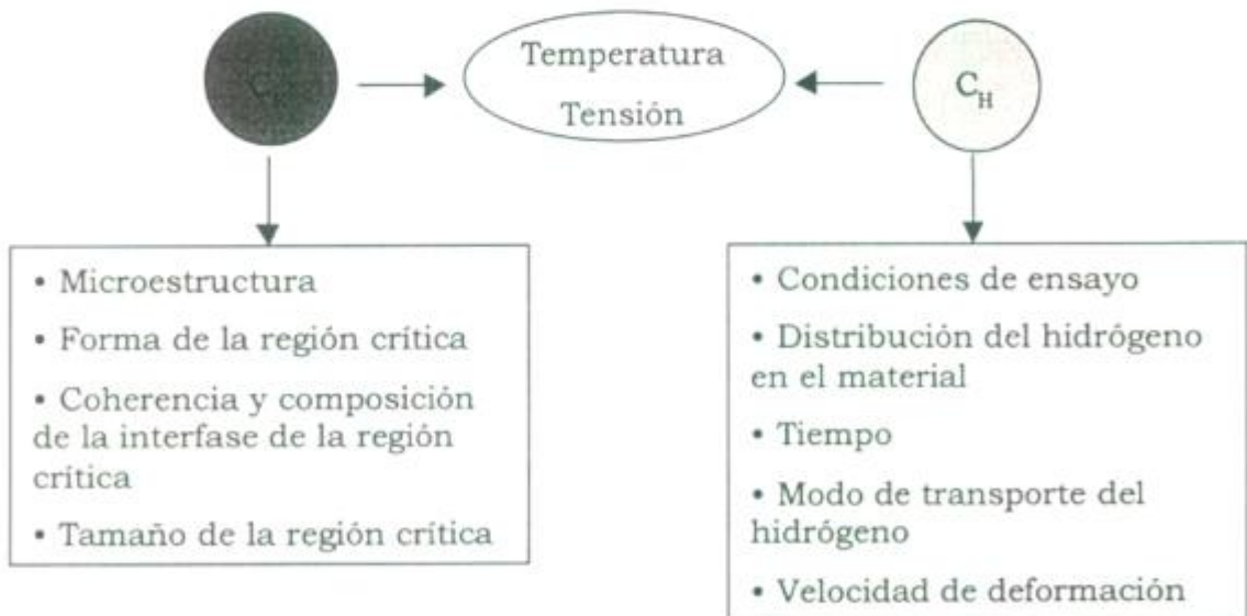
Figura 2.1. Factores que afectan la concentración crítica ( C_K ) y la concentración de hidrógeno ( C_H ) en un material.
