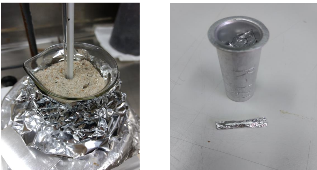
Fig. 6 – Baño de arena para evaporación en ampollas, y can de irradiación
