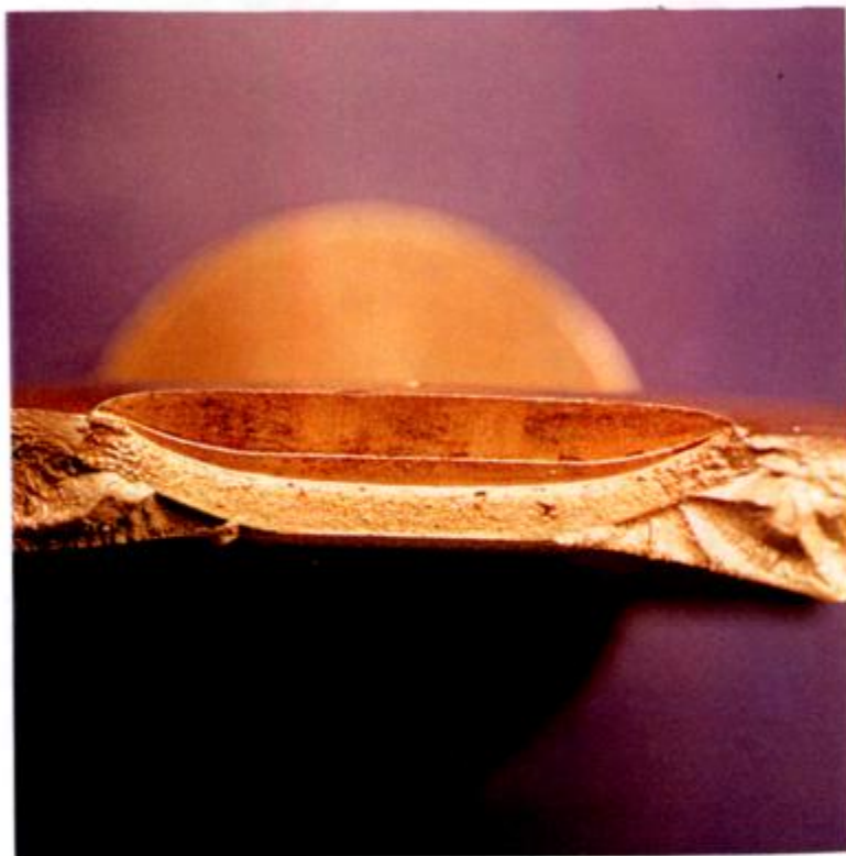
Figura 6-14: Zona del defecto en la probeta 4 (entalla, fatiga y ruptura)
