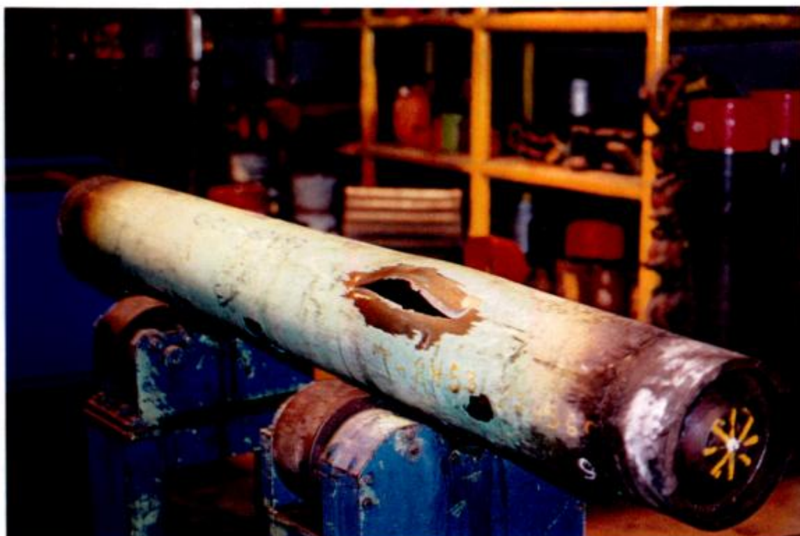
Figura 6-7: Ubicación y forma de la fractura en la probeta 1 (Propagación). La rotura no se produjo en el defecto.
