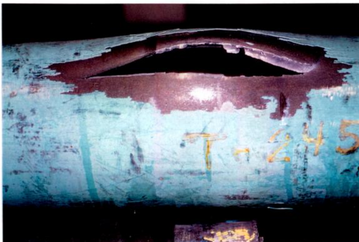
Figura 6-8: Aspecto de la fractura en la probeta 1 (tubo grado X65)
