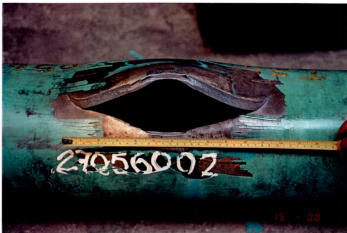
Figura 6-9: Aspecto de la fractura en la probeta 2 (tubo grado X65)
