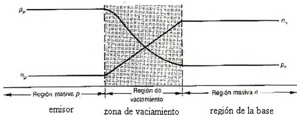
Figura 2.6. Esquema de las concentraciones de portadores en equilibrio térmico de una juntura p - n .
