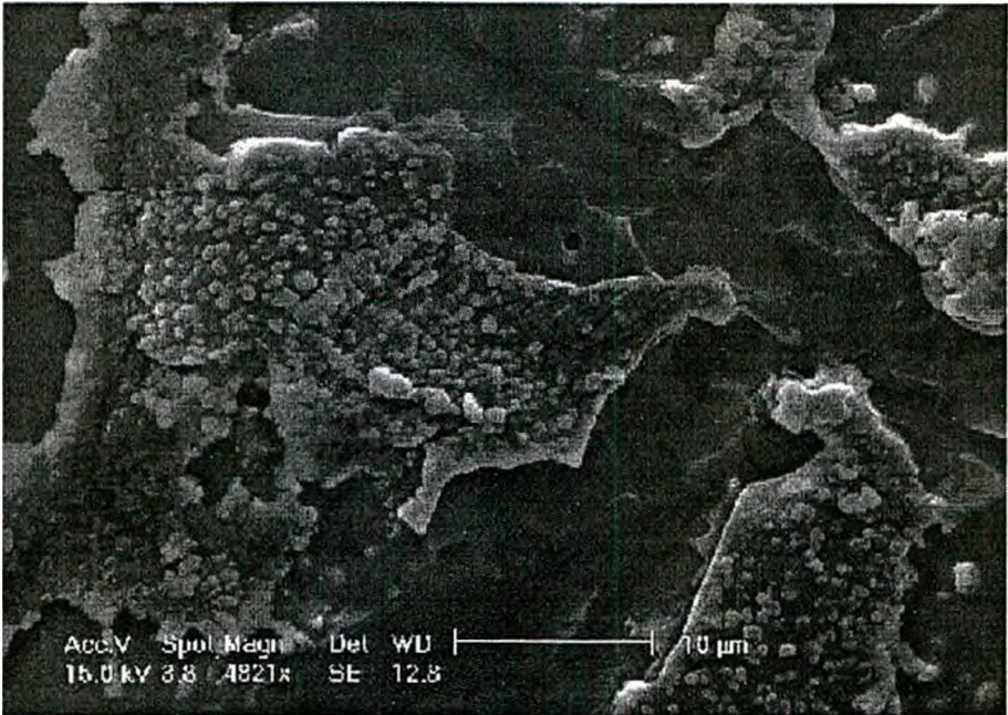
Figura 4.8. Micrografía de la superficie de Al difundido. Aumento: 4821X, escala: 10µm
