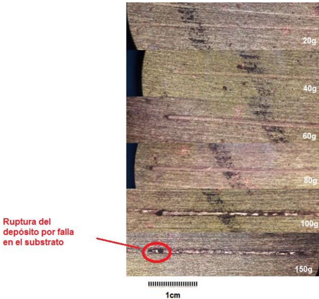
Figura 56 Análisis del desgaste superficial, comparación de superficies (muestra no irradiada).
