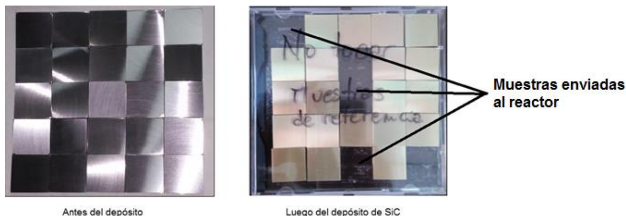
Figura 47 : Se aprecia las muestras de aluminio antes y después del proceso 4, se detalla que muestras fueron enviadas al reactor para ser irradiadas con neutrones.
