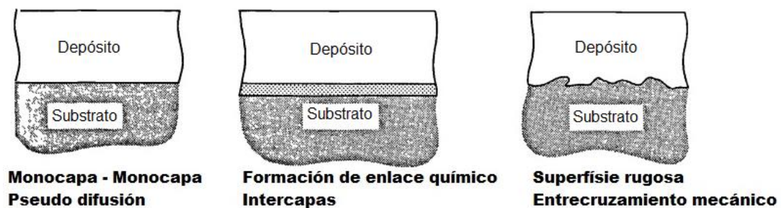
Figura 11 Tipos de estructuras interfaciales [7]
