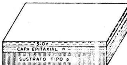
Fig. 13. Proceso fotolito gráfico para "abrir ventanas" en la su perficie del cristal.
