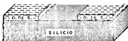
Fig. 13. Proceso fotolito gráfico para "abrir ventanas" en la su perficie del cristal.
