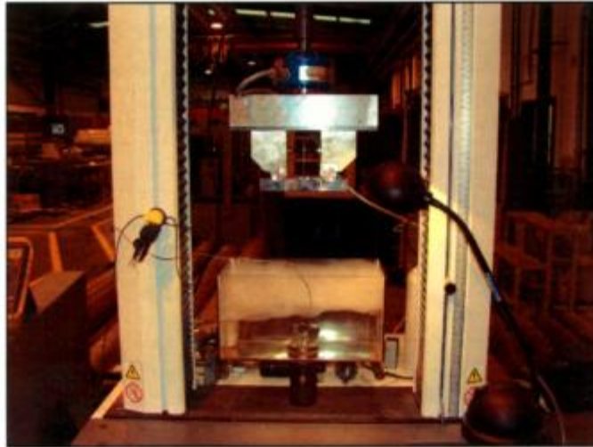
Figura 3.17. Montaje de probeta en dispositivo para ensayo de CTOD.
