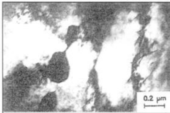
Figura 2.26. Borocarburos \text{Fe}_{23}(\text{B}, \text{C})_6 precipitados en bordes de grano austeníticos.
