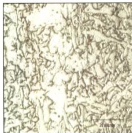
Figura 4.8. Microestructura de zona columnar para los cupones CF-1 y CFT-1
