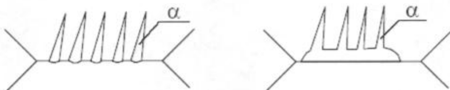
Figura 2.14. Morfología de las placas laterales.(8)
