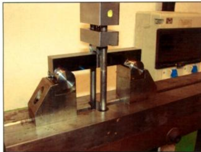
Figura 3.16. Montaje de probeta en dispositivo para prefisurado.
