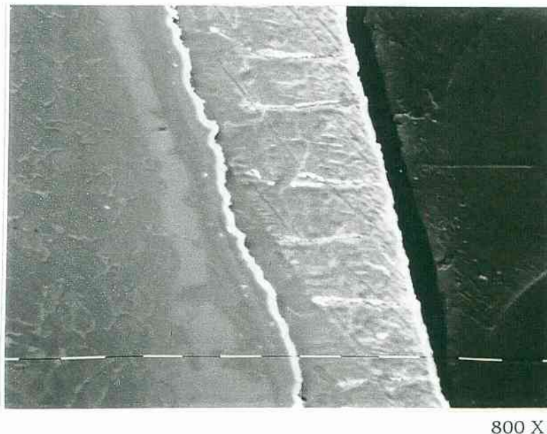
Figura 4.7.: Microestructura del recubrimiento Hot-Dip. Dendritas perpendiculares a la superficie. Vista en el espesor de la chapa (SEM) - Bajo tenor de Sb
