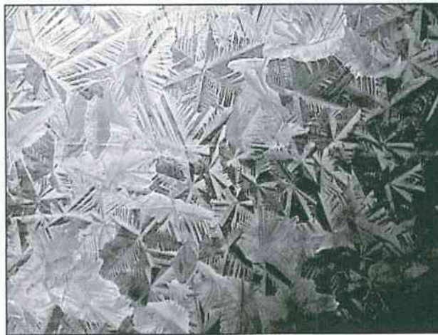
Figura 4.2. : Flores de material de línea con alto tenor de Sb: a) tipo "hoja de palmera", b) tipo "redondeada"
