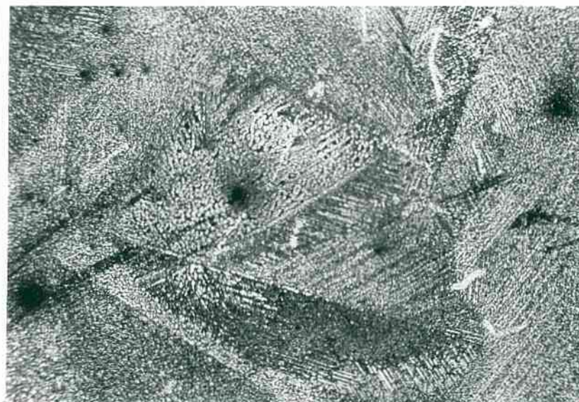
Figura 5.18. : Tamaño de flor en probetas con enfriamiento natural – Bajo contenido de Cd (Microscopio óptico)
