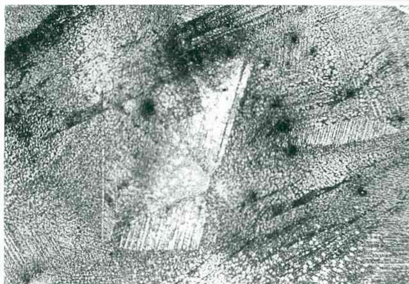
Figura 5.19. : Tamaño de flor en probetas con enfriamiento natural con escurrido – Bajo contenido de Cd (Microscopio óptico)
