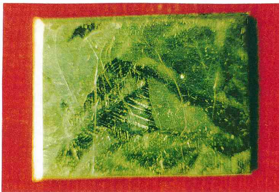
Figura 4.12.: Chapa galvanizada con improntas en limite de sectores opaco-brillante
