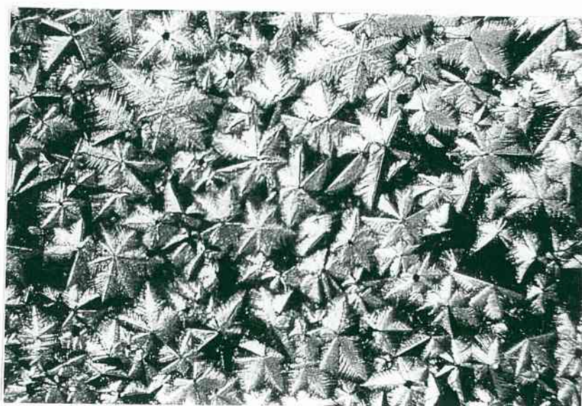
Figura 5.3. : Flor tipo "hoja de palmera", obtenida mediante enfriamiento acelerado (Microscopio óptico)
