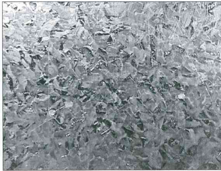
Figura 4.1. : Flores de material de línea con bajo tenor de Sb
