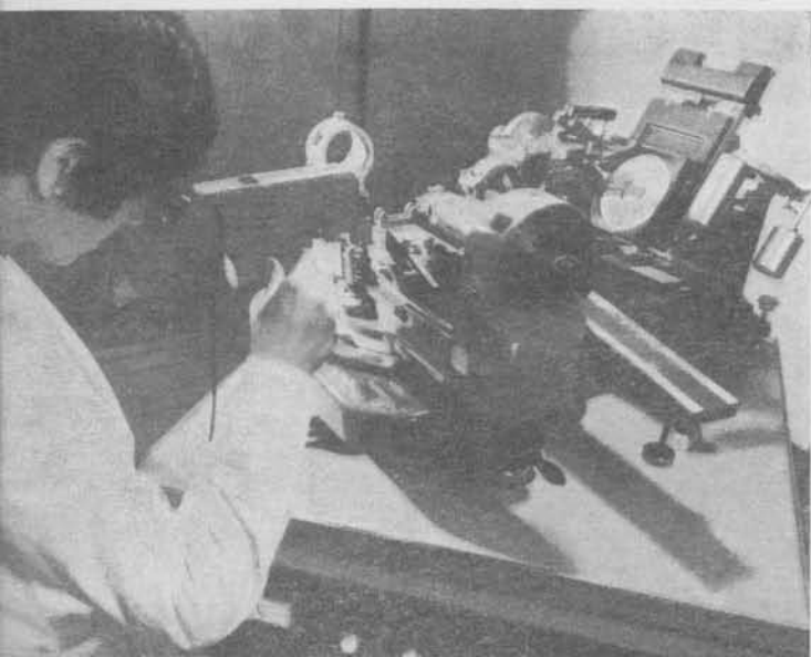
Laboratorio de Difracción de Rayos X. Cámaras Weissenberg y de precisión.
