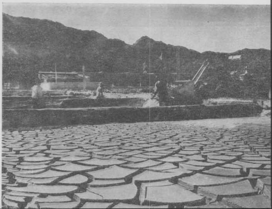
Mina de uranio "Don Otto" (Salta). Planta de lixiviación. Secado de preconcentrados.
