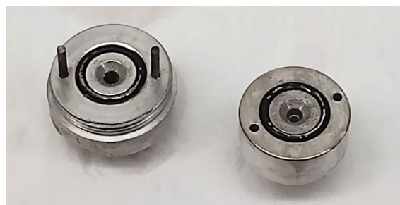
Figura 19. Fotografía de las mordazas de la unidad filtrante, en cuyos O-rings se evidencia el desprendimiento de la capa de titanio.
