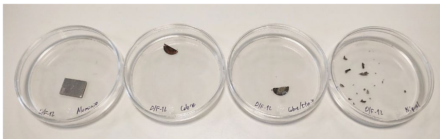
Figura 15. Muestras utilizadas para el condicionamiento de medio de cultivo en el ensayo de citocompatibilidad en placas de Petri de 100 mm de diámetro, de izquierda a derecha: aluminio, cobre, cobre/titanio y níquel.
