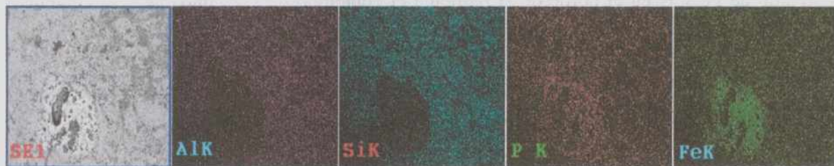
Figura 3.17: Mapeo elemental EDS sobre el material fosfato cerámico sin simulante
