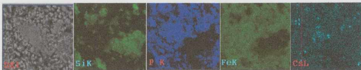
Figura 3.18: Mapeo elemental EDS sobre el material fosfato cerámico con SIM 2
