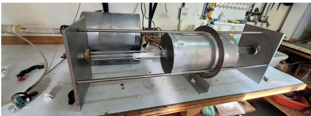
Figura 4.1 Horno tubular empleado para realizar el tratamiento termoquímico de reducción empleando Ar y H 2 húmedos. El mismo posee la posibilidad de desplazar la cámara del horno para enfriar rápidamente.
