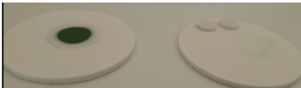
Figura 2.4 Celda B (izquierda) celda A y pastillas de YSZ (derecha) luego del depósito con GDC y posterior tratamiento térmico.
