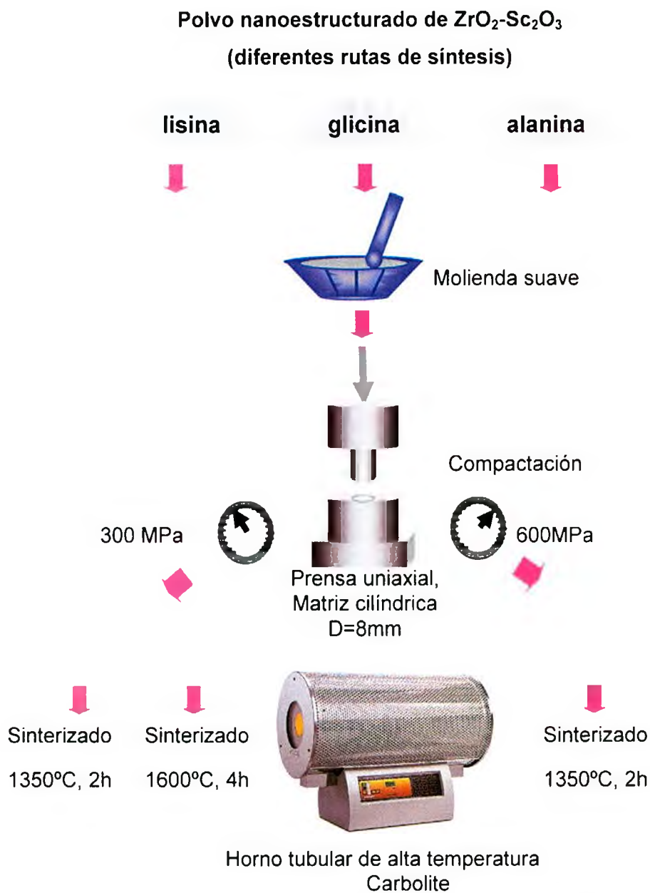
Figura 5.4: Esquema de preparación de las pastillas cerámicas.
