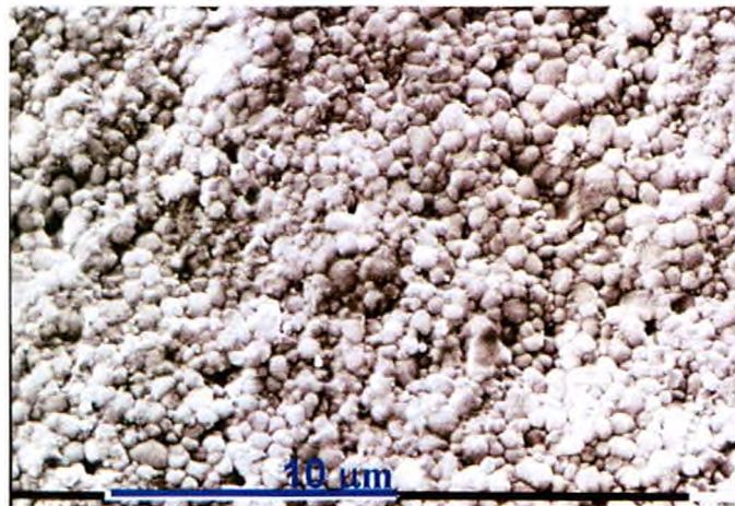
Figura 5.14: Micrografía SEM de cerámicos preparados a partir de la ruta nitrato-glicina. P_c : Presión de compactación. T_s : Temperatura de sinterizado.
