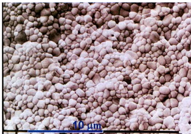
Figura 5.13: Micrografía SEM de cerámicos preparados a partir de la ruta nitrato-lisina. Pc: Presión de compactación. Ts: Temperatura de sinterizado.
