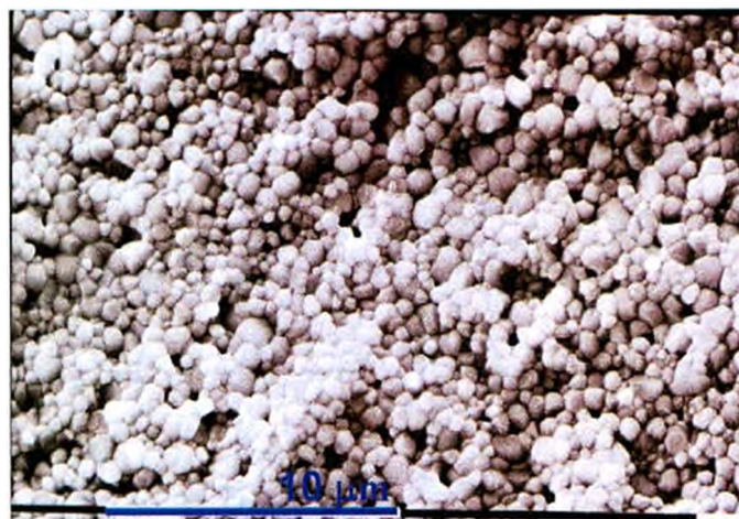
Figura 5.12: Micrografía SEM de cerámicos preparados a partir de la ruta nitrato-alanina. P_c : Presión de compactación. T_s : Temperatura de sinterizado.
