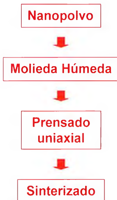
Figura 4.1: Esquema de preparación de las muestras cerámicas.
