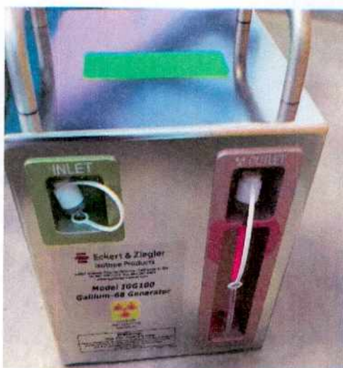
Fig. 13. Generador de ^{68}\text{Ge}/^{68}\text{Ga} de Eckert & Ziegler utilizado.
