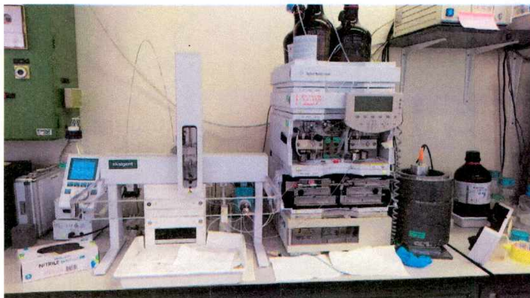
Fig. 17. HPLC con detector radiométrico utilizado para seguir el rendimiento de la radiomarcación con Lutecio-177.
