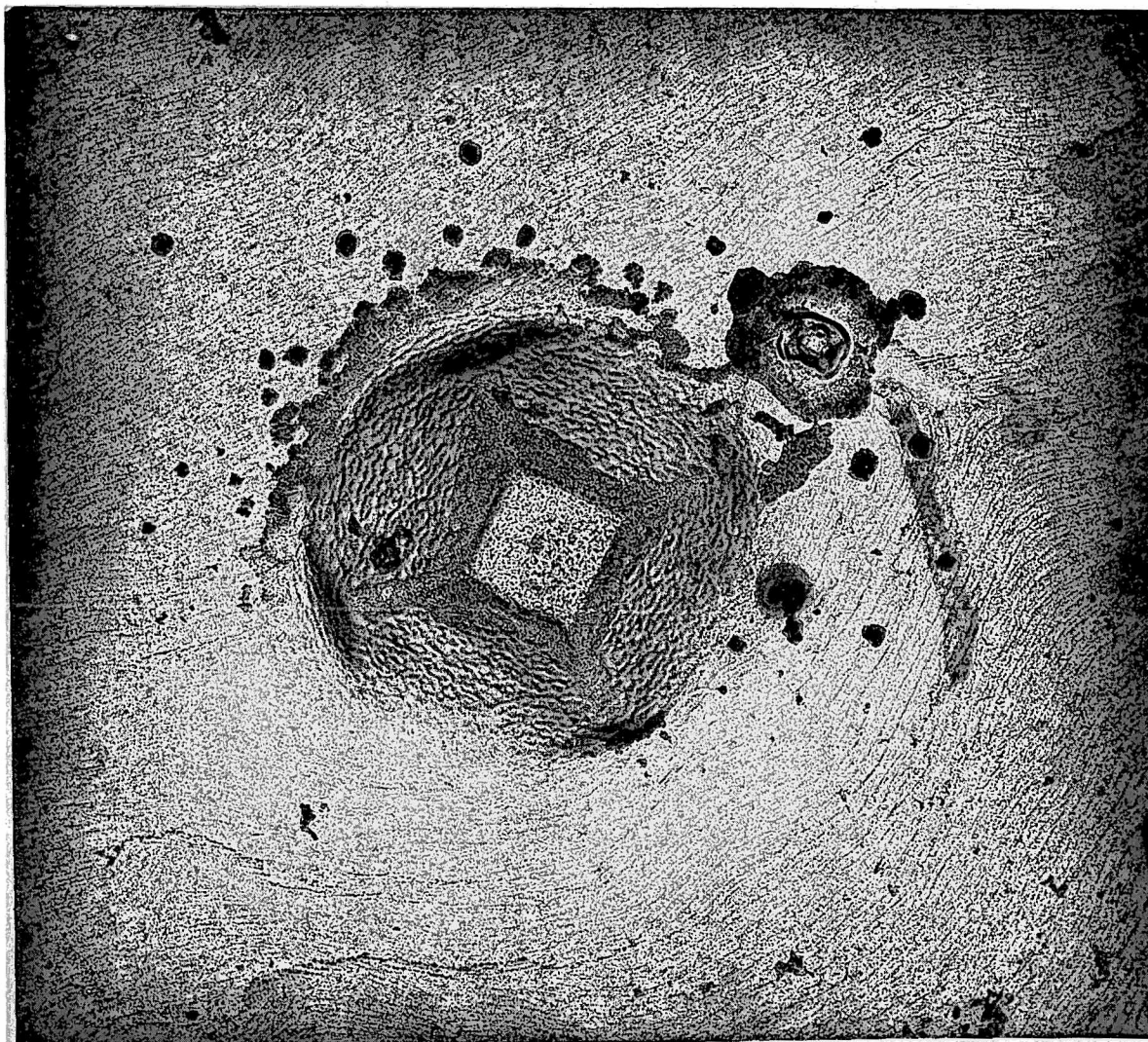
Fig.10: Réplica de óxido obtenida a partir de la superficie de una muestra de aluminio 99.99% pulida electrolíticamente y luego anodizada. Se puede observar la picadura característica del pulido electrolítico. M = 8000 x
