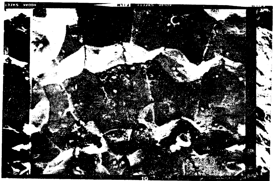
Microfractografía de la aleación Zr-Al
