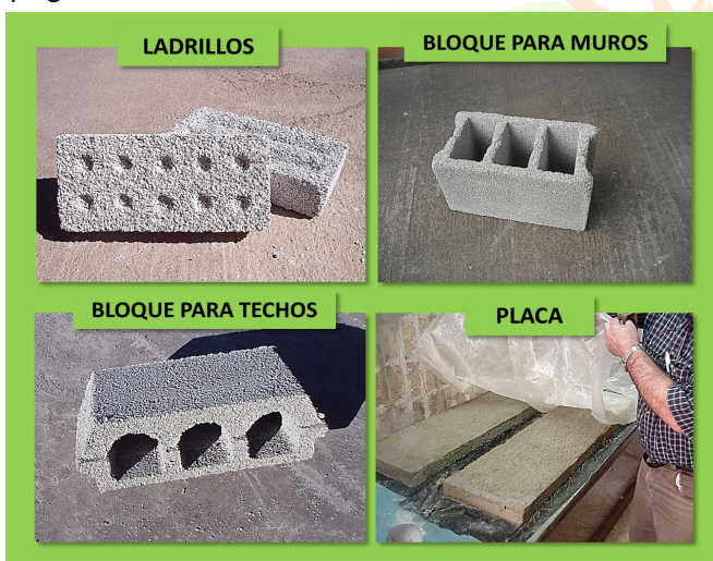
Fig. 1- Distintos elementos constructivos fabricados con PET reciclado.
