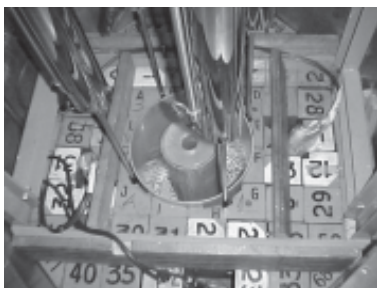
Núcleo del reactor de docencia RA-0 Universidad Nacional de Córdoba Pcia. de Córdoba
