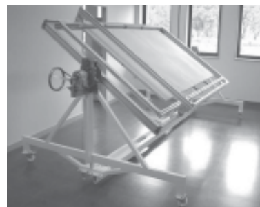
Proyecto Paneles solares Soporte giratorio con sistema de posicionamiento 3-D para la integración de módulos
