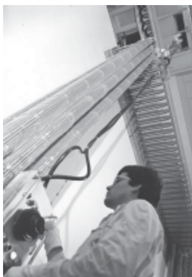
Elementos combustibles para la Central Nuclear Atucha I fabricados por CONUAR S.A.
