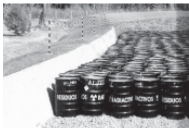
Almacenamiento temporario en tambores de residuos de baja actividad - Área de Gestión Ezeiza
