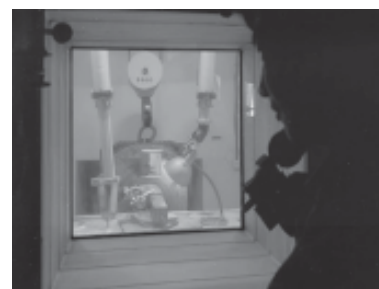
Planta de Producción de Fuentes selladas de Cobalto 60 Interior de la celda Centro Atómico Ezeiza – Pcia. de Buenos Aires
