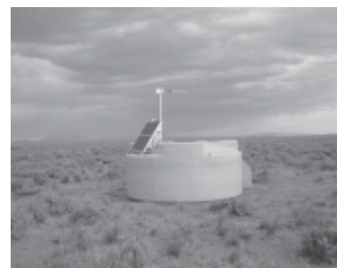
Proyecto Internacional Pierre Auger Detector de superficie
