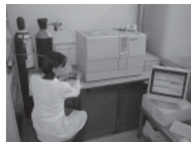
Cromatógrafo de masas para identificación de alimentos irradiados - Laboratorio de Efluentes y Productos Irradiados Centro Atómico Ezeiza Pcia. de Buenos Aires
