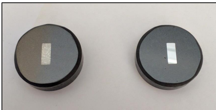
Figura 3.5 Muestras utilizadas para microscopía óptica y SEM.
