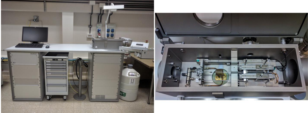
Figura 3.3 Dilatómetro Bähr modelo DIL 805 A utilizado en este trabajo.
