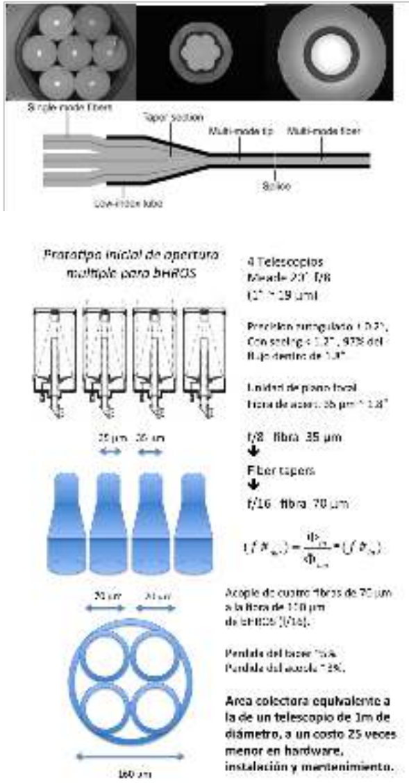
Figura 3: El panel superior muestra un ejemplo de fusión de siete fibras ópticas en una sola, usando el sistema de fiber taper . Panel inferior: prototipo del sistema de cuatro telescopios con el que a la vez se produce un aumento de la razón focal desde f/8 en los telescopios Meade a f/16 en la entrada del BHROS. El diseño preliminar incluye una configuración de cuatro telescopios de 0.35 m sumados al de 0.5 m.
