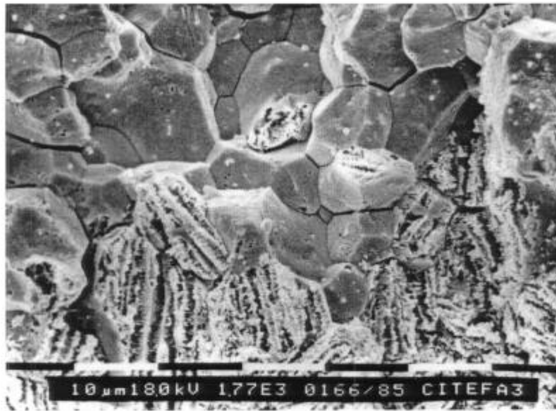
Figura 3.49b. Detalle de la superficie de fractura de un alambre de Zry-4 traccionado en KBr 1M. E=0,56 V_{enh} . T=40^{\circ}C . Vel. de def. =4,6 \times 10^{-6} s^{-1} (x1700)
