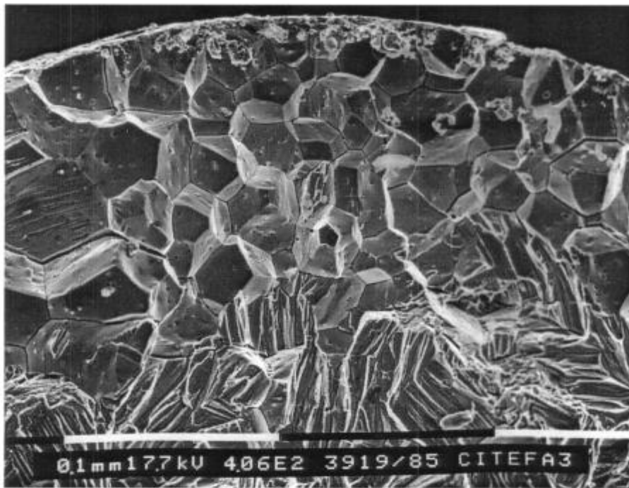
Figura 3.23a. Superficie de fractura de un alambre de Zr traccionado en KBr 1M. E=0,62V_{enh} . Vel. de def. =7,56 \times 10^{-4} s^{-1} . Inicio de la fisuración (x440).
