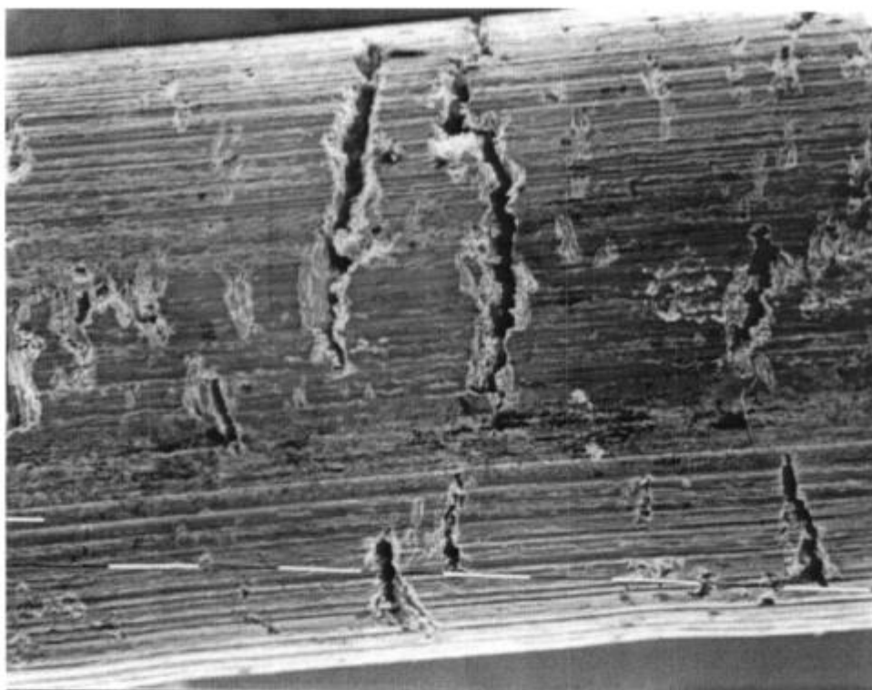
Figura 3.10. Fisuras y picaduras en la superficie lateral de un alambre de Zr en NaCl IM. Potencial levemente superior al de picado. ( E=0,39 V_{enh} ). Vel. de def. =4,6 \times 10^{-6} s^{-1} (x145)
