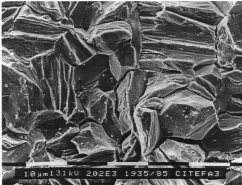
Figura 3.44. Superficie de fractura de un alambre de Zry-4 traccionado en KI 1M. Detalle de la zona transgranular. E=0,99 V_{enh} . Vel. de def. =3,73 \times 10^{-3} s^{-1} (x2250)
