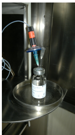
Figura 1.9.: Transferencia del producto final, frasco estéril y filtro millipore
