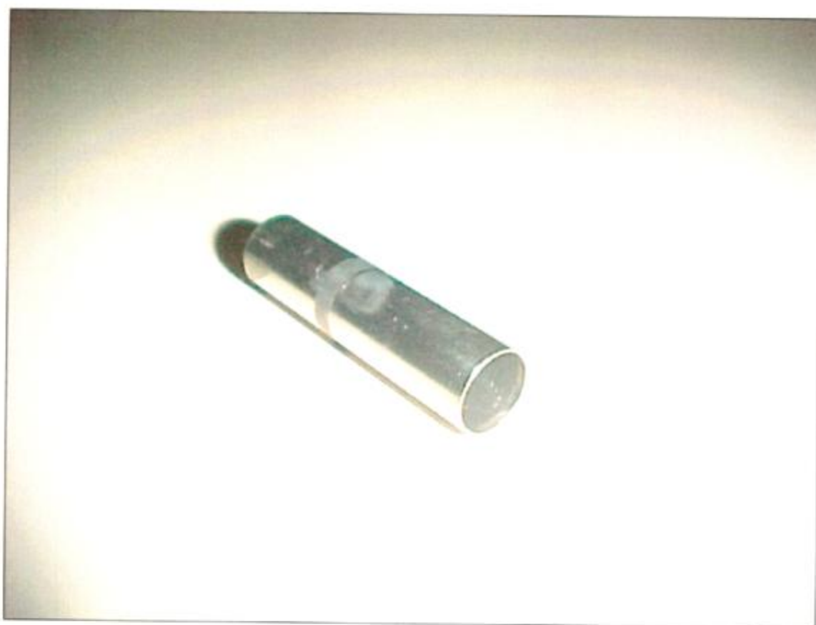
Figura 59: Marcas de fretting sobre la probeta ensayada bajo una luz diametral de 0,38mm.
