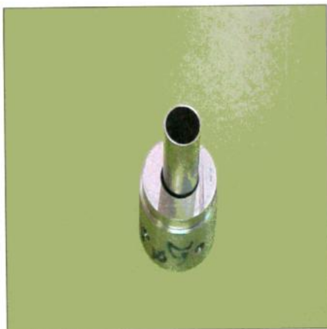
Figura 23: probetas utilizadas para los ensayos de fretting/impacto.
