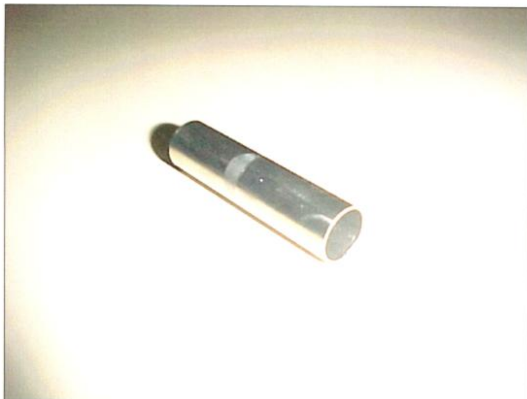
Figura 60: Marcas de fretting sobre la probeta ensayada bajo una luz diametral de 0,77mm.
