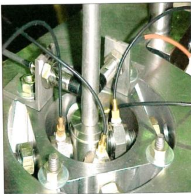
Figura 25: Vista de los sensores de fuerza y desplazamiento utilizados durante los ensayos.
