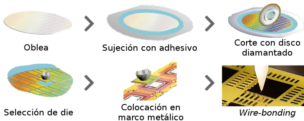
Figura 3.10: Proceso de empaquetamiento. La oblea con los dispositivos fabricados es cortada con un disco diamantado. Luego, cada die es fijado a un marco metálico. El proceso continúa con la conexión eléctrica por WB.
