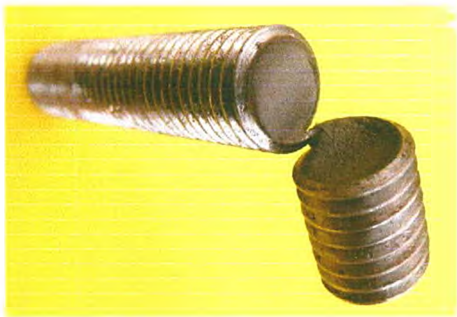
Figura 5.18 - Morfología de la fisura generada en la probeta en un ensayo hasta la rotura total.
