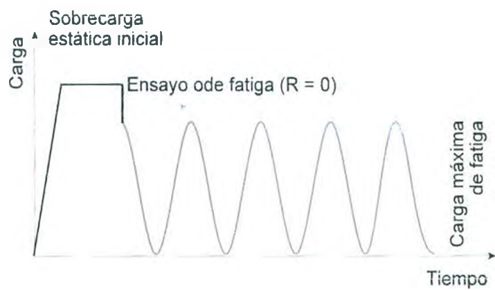
Figura 4.3 - Esquema de carga aplicado sobre las probetas.
