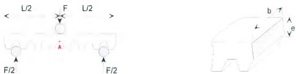
Figura 4.4 - Esquema de viga simplemente apoyada empleado en el modelo.
