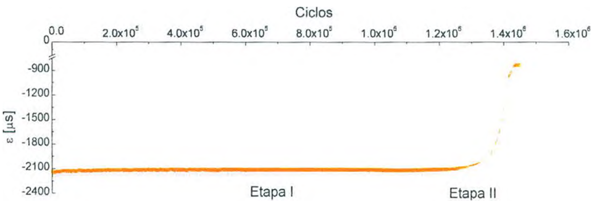
Figura 5.16 - Registro de la deformación en el cilindro obtenido mediante el equipo de extensometría.
