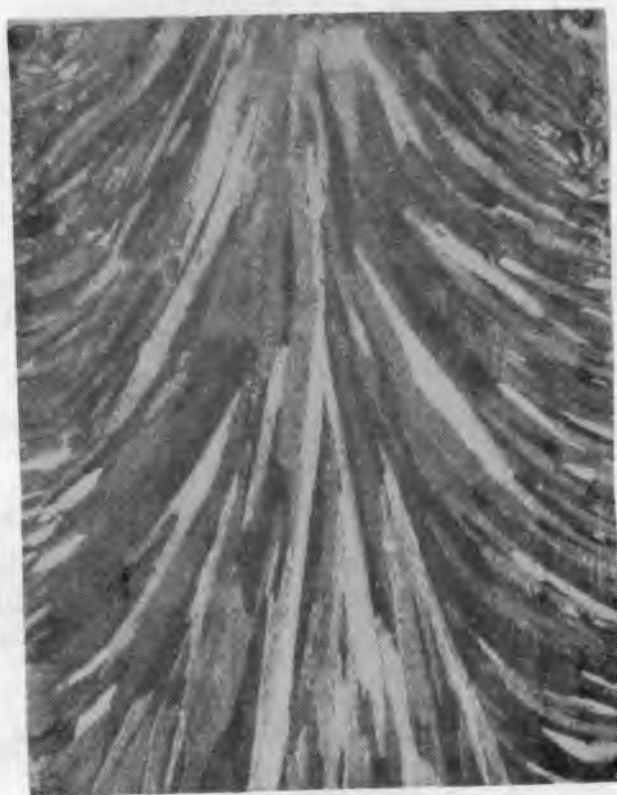
Figura 21.-Macroestructura de un lingote de molibdeno conteniendo 0,052% C. (Atacado con \text{NO}_3\text{H} al 50%. X2.
