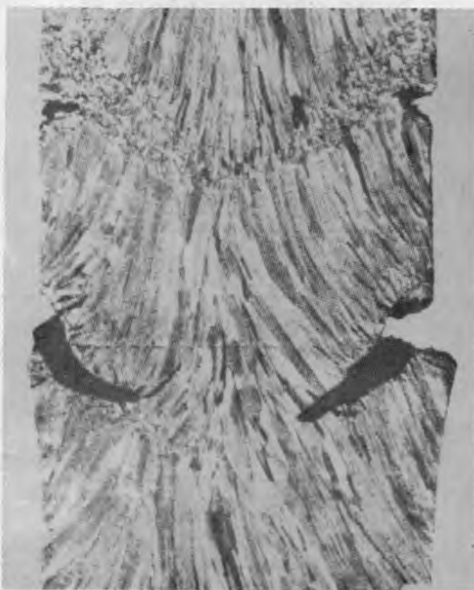
Figura 27.-Rajaduras por laminado correspondientes a un cambio de estructura granular.
