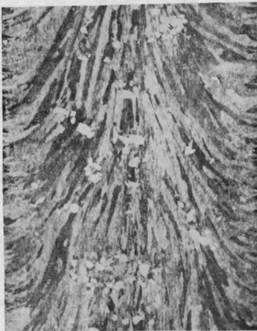
Figura 15.-Segregación de partículas de tungsteno en un lingote de molibdeno-tungsteno.
