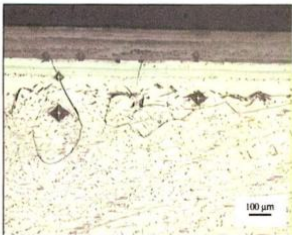
Figura 31/4: Micrografía óptica de una muestra tratada a 940°C durante 40 min.
