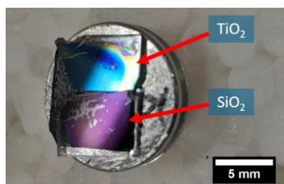
Figura 2.1 Fotografía del montaje de una película de \text{TiO}_2 moldeada con Brij 58 y una película formada por NPs de \text{SiO}_2 sobre un taco de aluminio para observaciones de MEB.
