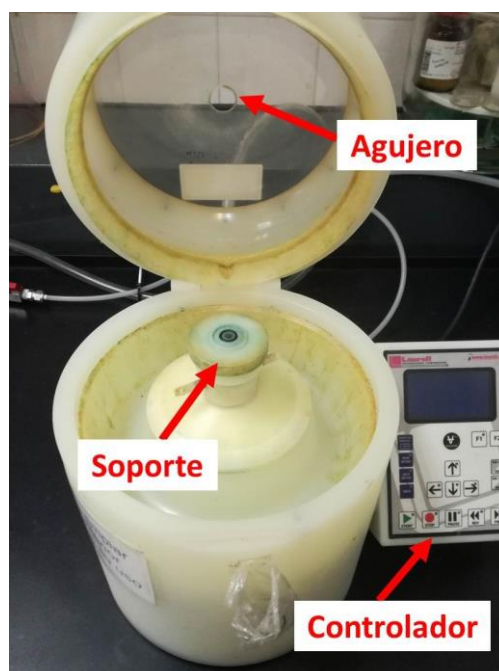
Figura 4.9 Spin coater utilizado para la síntesis de films mesoporosos mono, bi y multicapa.
