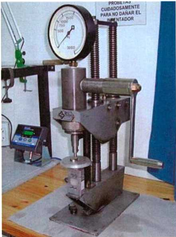
Figura 4.15. Fotografía del porta probetas y de la celda de carga.
