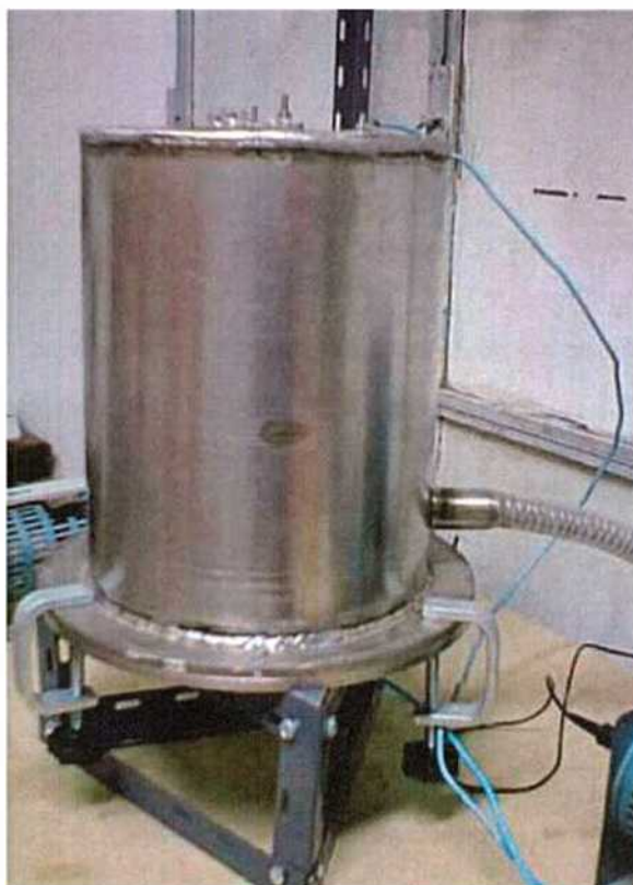
Figura 4.5. Foto del reactor de nitruración iónica desarrollado por el GIS.
