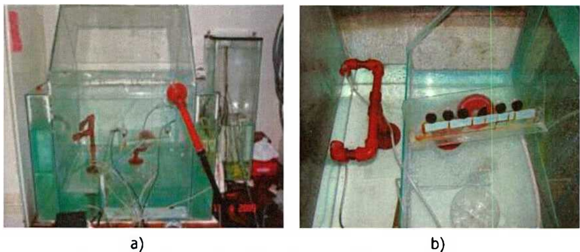
Figura 4.14. a) Foto de la cámara de niebla, b) soportes para probetas.
