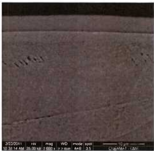
Figura 5.2. Imagen SEM de la capa nitrurada en el acero inoxidable AISI 316L.
