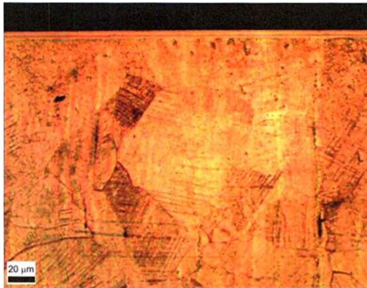
Figura 5.1. Micrografía óptica de la capa nitrurada en el acero inoxidable AISI 316L.
