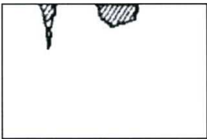
Figura 2.51. Corrosión por picado [88].
