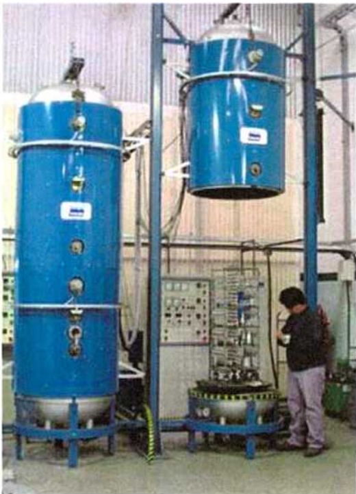
Figura 4.1. Fotos de los equipos de nitruración de Ionar.
