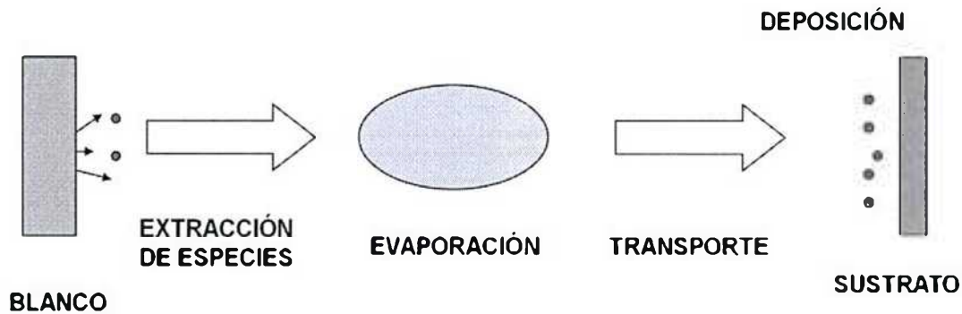
Figura 2.14. Esquema del proceso PAPVD [41].
