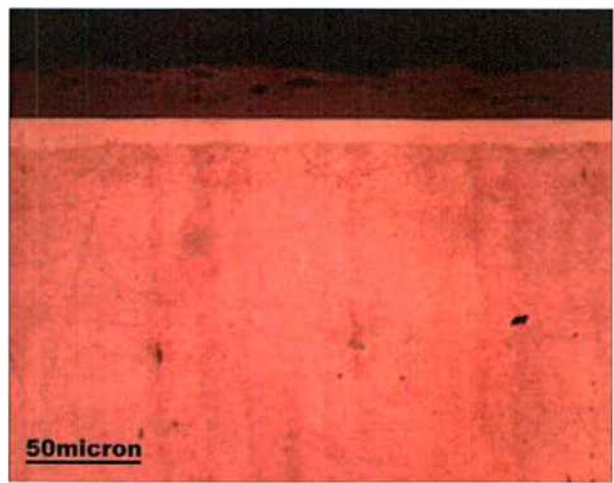
Figura 5.73. Micrografía óptica de la muestra N (BT)+DLC (S).
