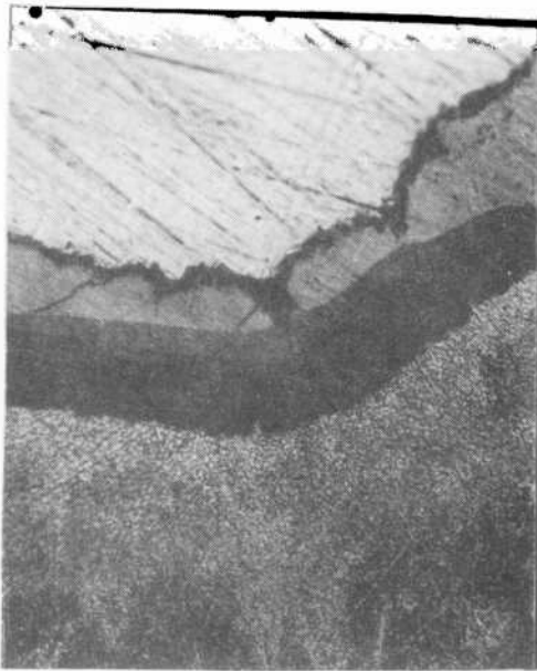
Fig. 2.9.1 - zona de interdifusión en Zircaloy-4/Cu.
