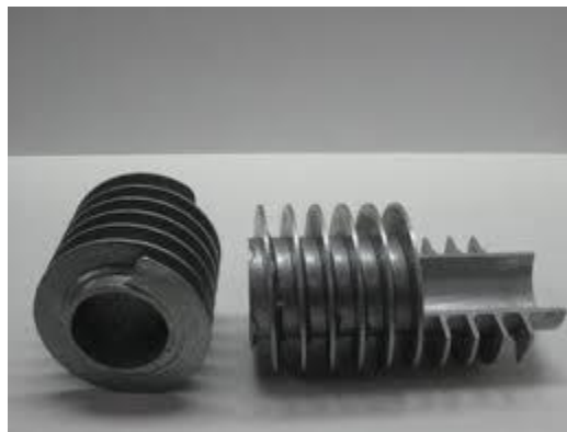
Fig. 4.7: Tubo aletado de acero inoxidable.
