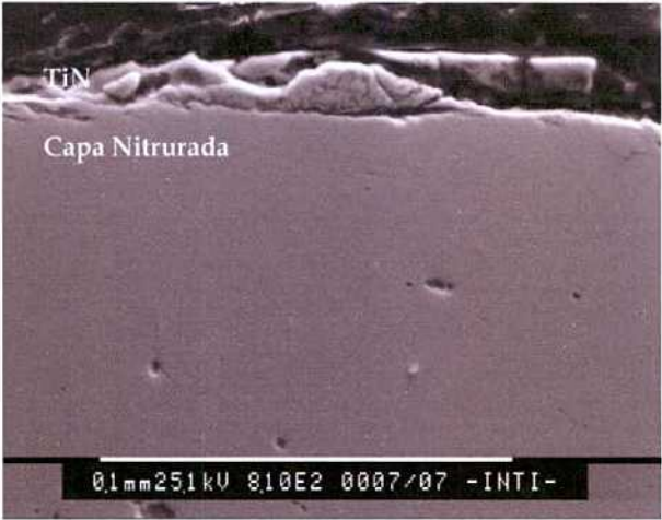
Figura .4.30: Micrografía SEM de muestra D, ensayada bajo carga normal de 1225 N
