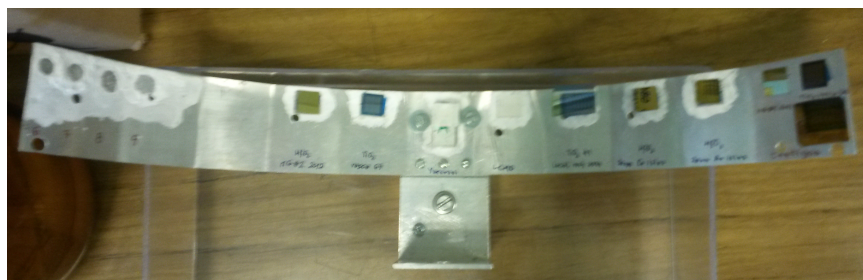
Figura B.1: Fotografía del portamuestras. A la izquierda se aprecian los 4 círculos determinados con fósforo (se pone de manifiesto que fueron delimitados pintando el exterior de los mismos). A continuación se ubican las muestras, una por pliegue del anillo. En el tercer lugar lo que se aprecia es la pequeña pieza de aluminio que soporta la muestra de GaAs que fue irradiada lateralmente. En el panel derecho (último pliegue del anillo) se ubicaron las muestras testigo que sufrieron el mismo estrés mecánico que las que fueron sometidas a la radiación. Como se desprende de la observación cuidadosa del entorno de las muestras, los alrededores de cada posición fueron pintados con fósforo también para apreciar posibles derivas o deformaciones del haz durante el propio proceso de radiación.
