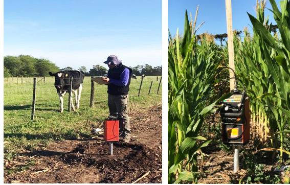
Fig. 4 - Empleo de una sonda de neutrones para determinación de contenido hídrico del suelo.
