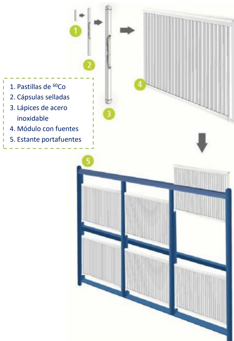
Figura 3. Esquema del arreglo de lápices de ^{60}\text{Co} en módulos ubicados en un estante portafuentes [85]
