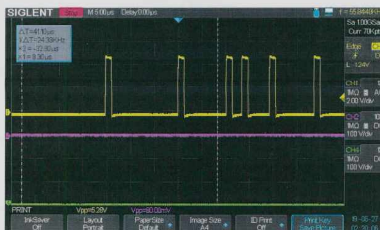
Figura 3.20: Captura de la señal generada por el generador de pulsos CNEA E023-A0.
