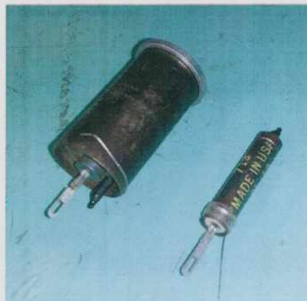
Figura 3.8: Fotografía de los tubos detectores utilizados: LND-7224 (izquierda) y LND-713 (derecha).
