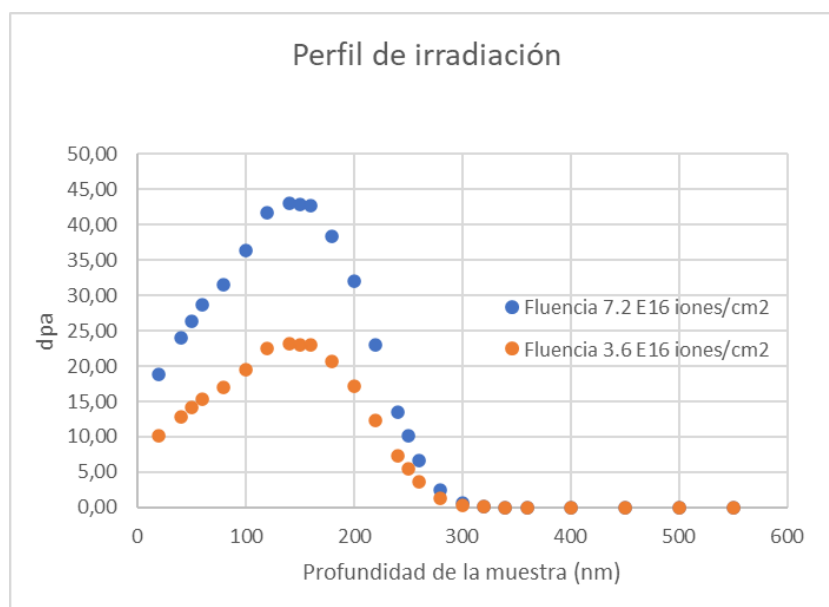
Figura 65: Curva de penetración de iones carbono. Valores de dpa en función de distancia a la superficie. Los valores máximos se alcanzan a 170 nm de la superficie.
