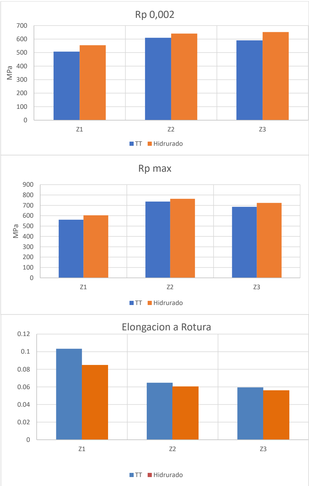
Figura 52: parámetros mecánicos obtenidos en ensayo de tracción para materiales hidrurados y TT
