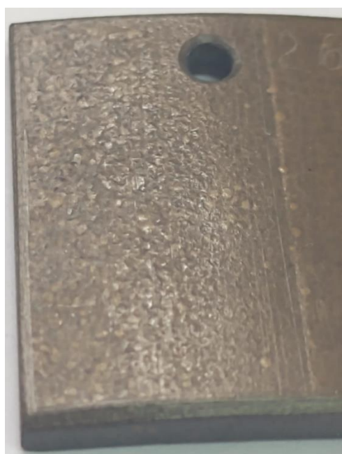
Figura 4. 15 – Muestra M 25-26 con ampollas sobre la cara externa del tubo.
