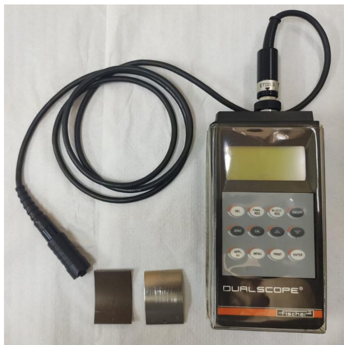
Figura 3. 11 - Equipo Fischer DualScope® MP40 y sonda Fischer ETD3.3 .
