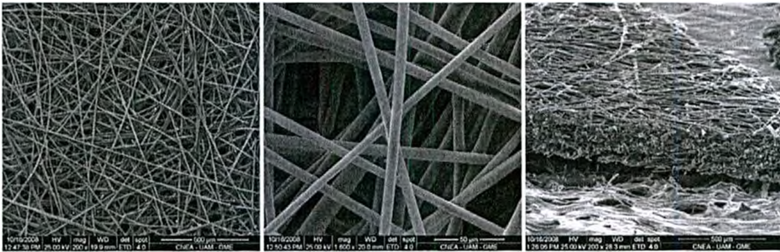
Figura 21: Imágenes SEM del papel Toray TGP-H-090 a distintas magnificaciones. A la derecha, se muestra una vista transversal del material.
