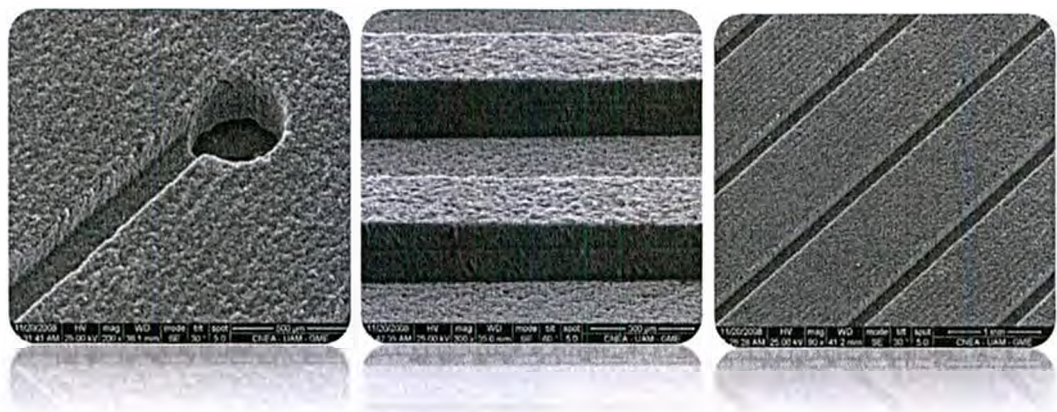
Figura 51: Imágenes SEM mostrando detalles del mecanizado.
