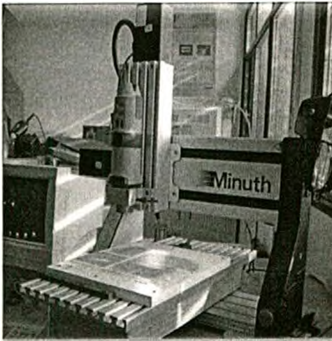
Figura 58: Máquina CNC y capa de LTCC cruda mecanizada.
