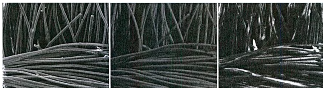
Figura 23: Imagen SEM de una tela de carbón (izquierda) y mapeo EDAX del C (medio) y del F (derecha). Aumento x800.
